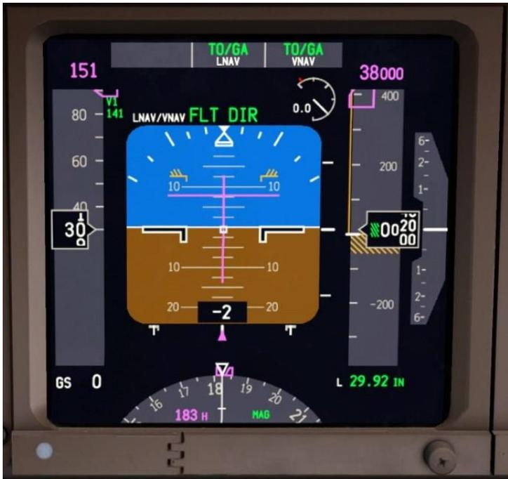
LNAV が地上でセットできない条件があることを、将来の補足として注意してください。特に、最初のレグのコースが滑走路方向から 5 度以上離れている場合は注意が必要です。
