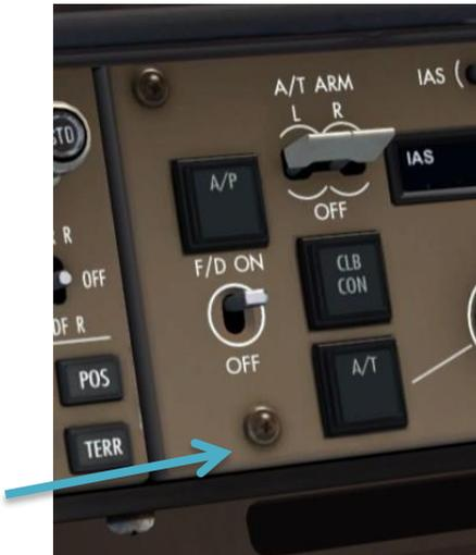
TO/GA ネジのクリックスポットは、過去の PMDG 製品と比較して **PMDG 777-200LR/F** の新機能を備えています。左クリックは TO/GA に繋がり、ミドル(ホイール)クリックは自動スロットルを切断し(スラストレバーのボタンと同じ)、右クリックするとオートパイロットが切断されます(ヨークのボタンと同じ)。
