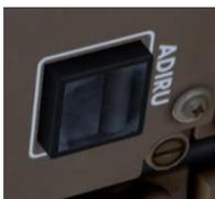
これは、慣性計測装置レーザジャイロの電源を落とします。これらは現在位置合わせを失い、元の通常表示に戻すために完全に再調整する必要があります。
