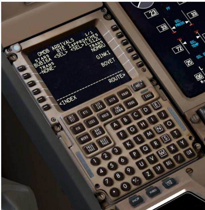
私達は今ここで、選択した手順を確認して、その一部として自動的に入力された高度と速度の制限が実際のチャートに正しく対応していることを確認する必要があります。
