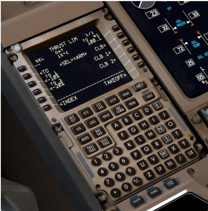
THRUST LIM ページでは、離陸および初期上昇のためのエンジンの推力レートを制御します。
