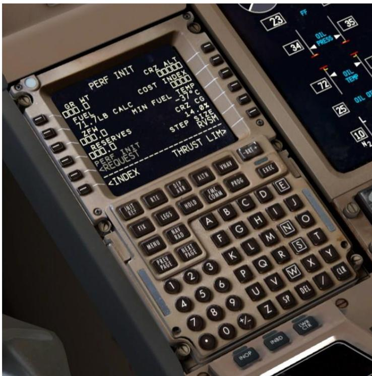
PERF INIT ページでは、クルーが FMC に航空機の運航重量が何であるかを伝え、コストインデックス(指数)等のパフォーマンスと垂直方向の経路に影響を与えるパラメータを設定します。これは、飛行での巡航高度が設定されている場所でもあります。
