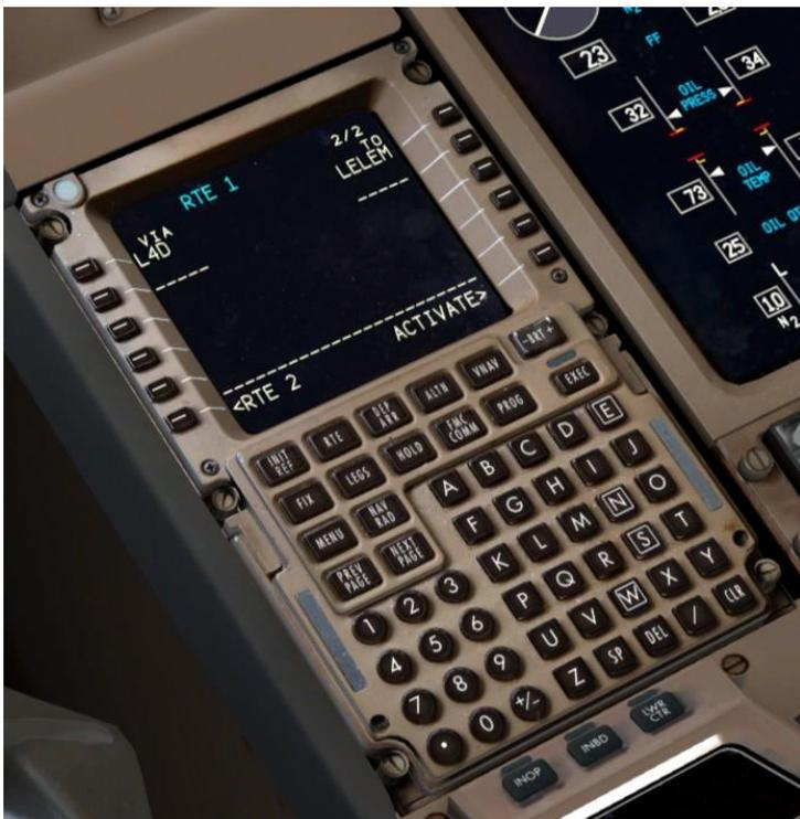
RTE ページ 2 にさらに、実際にルート情報を入力します。画面の左右にある VIA と TO の列は、私が高速道路の類推で前述で説明したものです。右側の TO の列はあなたが行く場所で、左側の VIA の列はあなたがどのようにそこにたどり着くかを表しています。SID の選択によって既に自動的に入力された 1 行があることがわかります。私達は L4D SID のプロシージャを通して LELEM に行きます。
