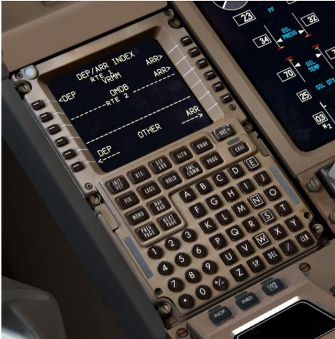
DEP/ARR INDEX ページには一連のプロンプトが表示され、RTE ページに入力した2つの空港の ORIGIN フィールドと DEST フィールドの出発と到着の手順の選択ページが表示されます。出発地の空港に出発と到着の両方のプロンプトが表示されるのは、離陸後の緊急時に空港に戻ることを説明するためです。出発地の空港の到着ページにすぐにアクセスできるようにすると、到着およびアプローチを素早く簡単に選択することができます。
